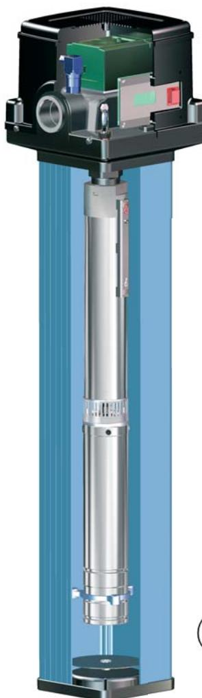
1. Compatto: elettropompa sommersa inserita in un contenitore con attacchi ingresso e uscita "in-line" con valvola di non ritorno integrata.
