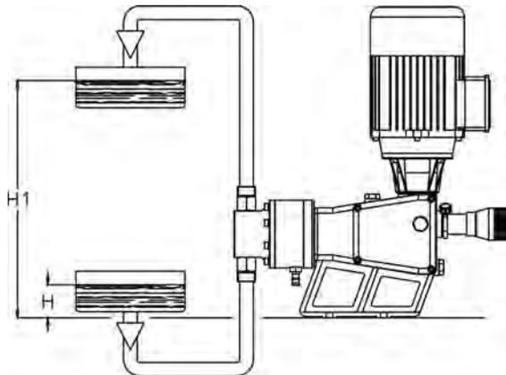
Fig. 11 – installazione sopra battente
