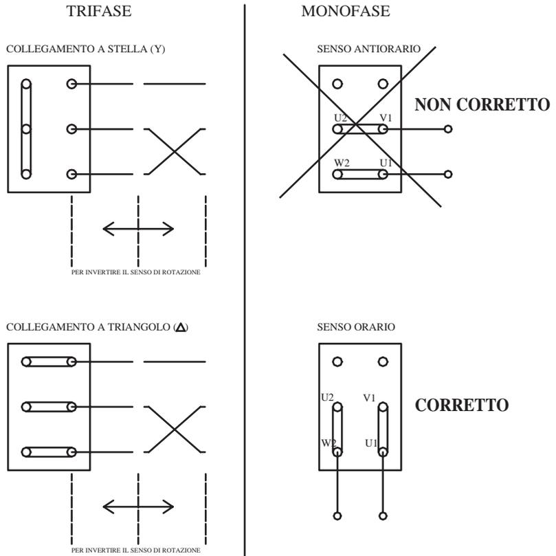
Fig. 17 - Schema di allacciamento alla rete elettrica
