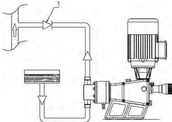
Fig. 13 – installazione con valvola di iniezione in mandata
