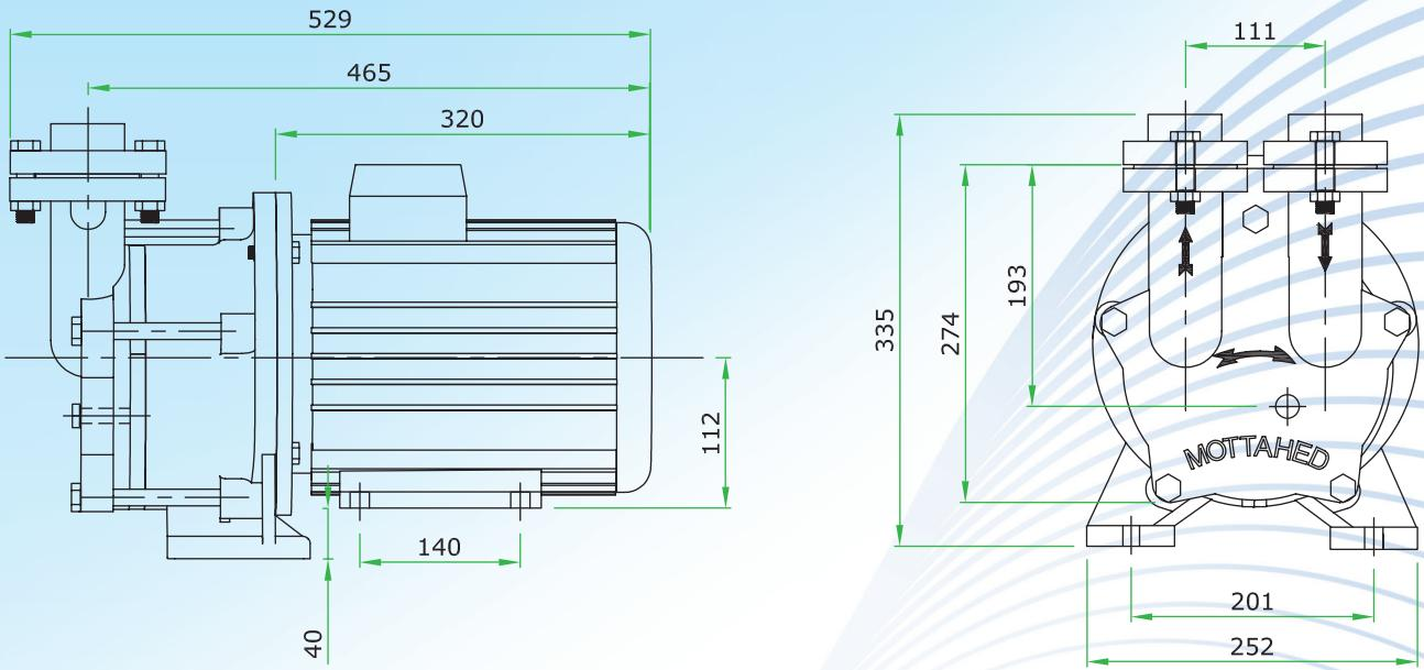
این پمپ از نوع رینگ مایع (آب در گردش) تک مرحله ای می باشد که عمل مکش را بصورت یک مرحله ای توسط سوپاپ و یک پروانه انجام می دهد. (Side plate)
